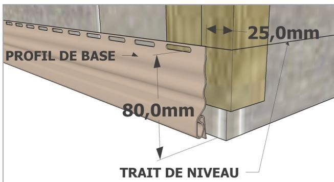
Commencez l'installation en traçant une ligne horizontale au cordeau, parallèle à l'avant-toit ou encore au haut et au bas des fenêtres.
