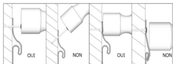
Les clous doivent être résistants à la corrosion avec une tête minimale de 45. Ne pas écraser la lame avec la tête du clou.
