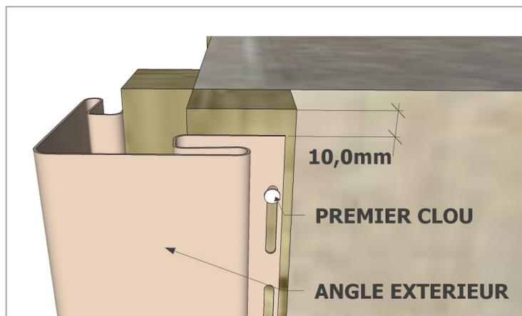
Posez les finitions d'extrémité de la même manière que les angles extérieurs. Ces deux types de profilés doivent être installés avant la pose des lames. Assurez-vous que ces profilés soient bien d'aplomb et d'équerre afin que toute l'installation soit bien horizontale et verticale. Procédez de la même façon pour toutes les ouvertures. Les lames Barlyte s'ajustent parfaitement à toutes les largeurs.
