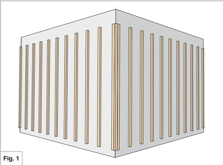
Prévoir une ossature sur la façade à habiller, perpendiculaire aux lames. Choisir vos tasseaux de façon à laisser une lame d'air de 37 mm minimum.
