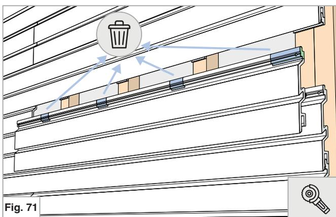
Encocher la lame au niveaux des tasseaux.
