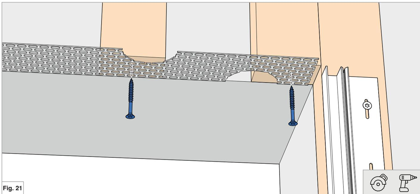
Installer la GARP sous les tasseaux en s'alignant à la maçonnerie.
