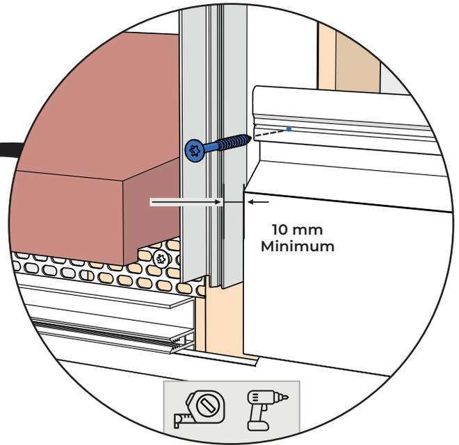
Découper la lame à la forme de l'encadrement en tenant compte du jeu de dilatation de 10 mm sur les côtés. Pour le dessus et le haut de l'ouverture laisser un jeu de 2 mm.
