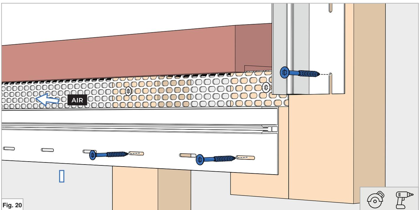
Fixer l'ISO-EF3 horizontale avec une vis par tasseau. Il doit être en appui contre la grille de ventilation. Pour les ISO-EF3 verticaux les visser avec une vis tous les 500 mm et une vis à chaque extrémité.
