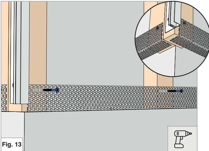
Installer la grille anti-rongeur GAR en partie basse en utilisant une vis par tasseau.
