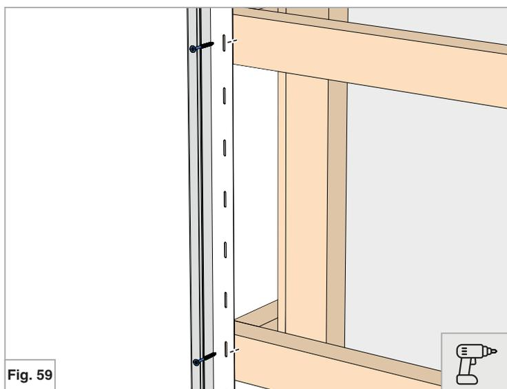
Fixer les ISO-EF3 verticaux avec une vis par tasseau
