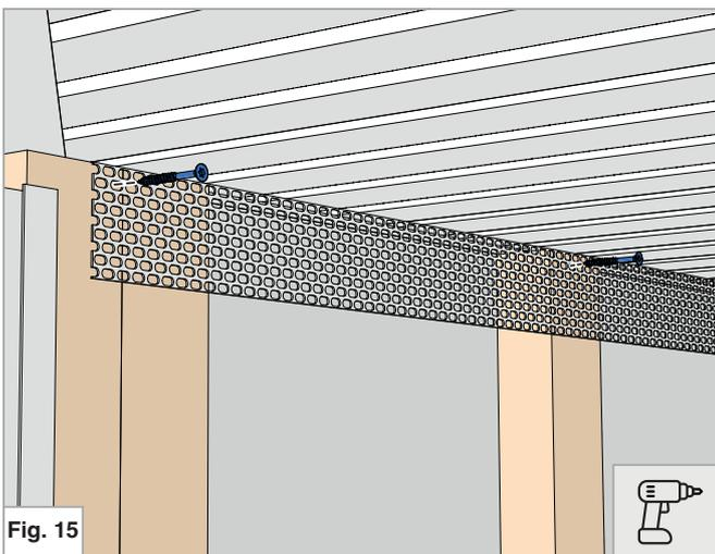
Installer la grille GARP en partie haute en utilisant une vis par tasseau.
