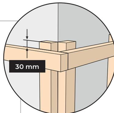
Pour une pose de bardage verticale rajouter un réseau de tasseaux horizontalement en superposition des tasseaux verticaux, afin d'avoir une lame d'air.
