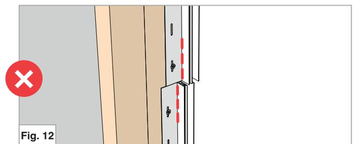
Fixer les ISO-EF3 verticaux avec une entraxe de vis de 500 mm maximum.
