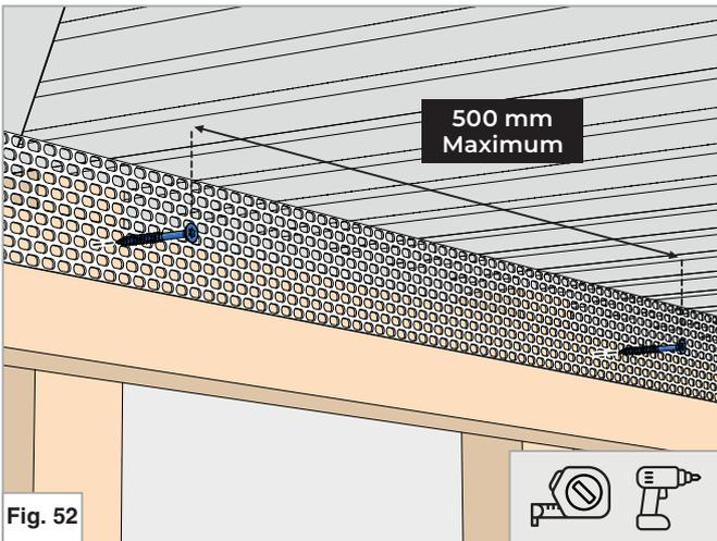
Installer la grille GARP en partie haute. Il est aussi possible d'utiliser la GAR27 en la fixant sur les tasseaux verticaux.
