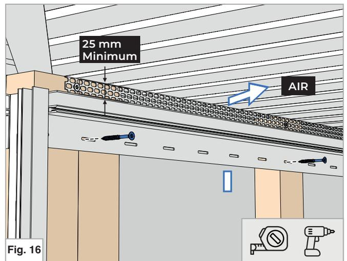
Fixer le fond commun ISO-EF3 en partie haute avec une vis par tasseau, laisser 25 mm minimum pour la ventilation.
