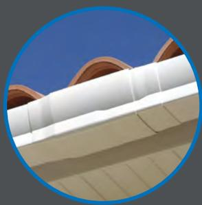
La besace unique de La Réversible® à grande capacité d'expansion, permet une maîtrise parfaite de la dilatation. Ce système de besace ouverte n'implique pas la pose de descente supplémentaire et permet la dilatation contrôlée de grandes longueurs (jusqu'à 12m) pour une variation de température de 70°C.
