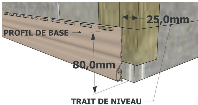
Commencez l'installation en traçant une ligne horizontale au cordeau, parallèle à l'avant-toit ou encore au haut et au bas des fenêtres.
