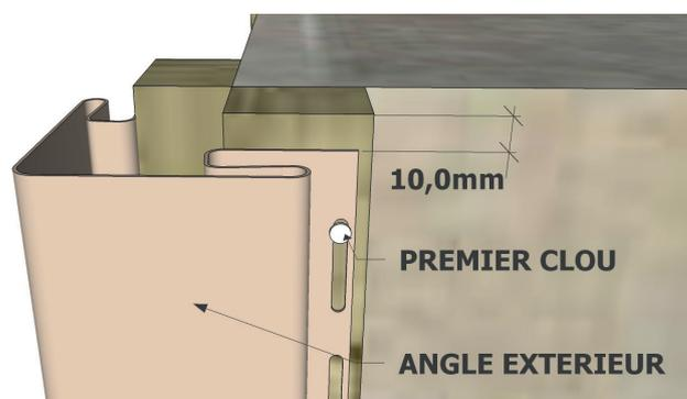
Posez les finitions d'extrémité de la même manière que les angles extérieurs. Ces deux types de profilés doivent être installés avant la pose des lames. Assurez-vous que ces profilés soient bien d'aplomb et d'équerre afin que toute l'installation soit bien horizontale et verticale.
